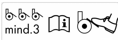
Teil C: Abb.1: Bremsen der Laufrollen
