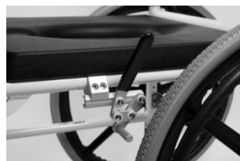
III. 4: Montage des freins sur le cadre
