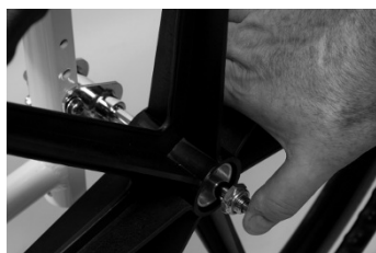
III. 2: Roue 24" avec blocage rapide
