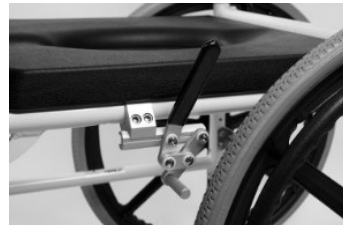
Fig. 4: Montering af bremsere på rammen
