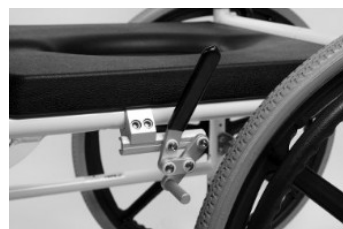
Abb. 4: Befestigung der Bremsen am Rahmen
