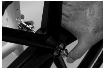
Fig. 2: 24"-hjulet med hurtigudløser
