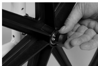
Abb. 3: Kappe für den Schnellspanner
