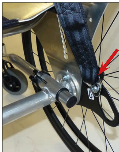
Befestigungspunkt, hinten nach ISO 7176-19 für Beckengurt
