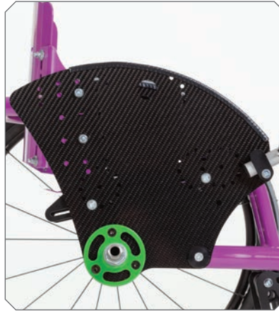
Basisplatte aus Carbon.
